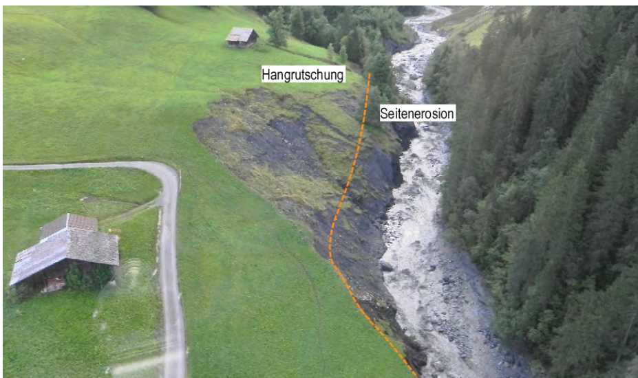
Abbildung 5: Abgrenzung von Seitenerosion und Hangrutschung. Beispiel Schwarze Lüttschine in Grindelwald. Foto Nils Hählen.
