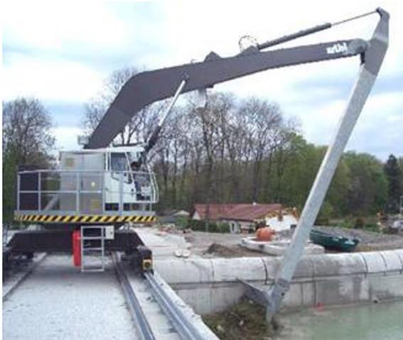
Abb. 3.21 Beispielfoto einer hydraulischen RRM (Quelle: Künz GmbH).
