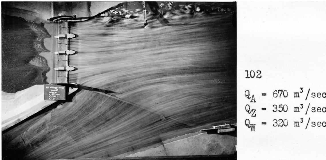
**Abb. 3.22** Strömungsaufnahmen am Kanaleinlauf mit der hohen Einlaufschwelle für einen Durchfluss im Zulaufkanal von  $Q_z = 350 \text{ m}^3/\text{s}$  und einem Wehrüberfall von  $Q_w = 320 \text{ m}^3/\text{s}$  [19].
