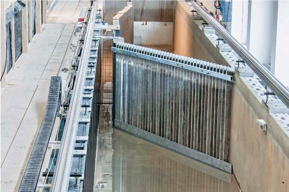
Abbildung 8: Leitrechen mit installiertem Leitblech.
