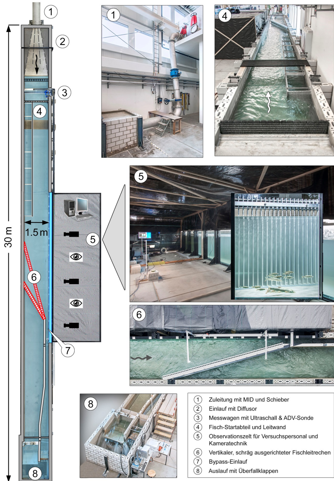
Abbildung 4.13 Gesamtsituation des ethohydraulischen Versuchsstandes mit Detailausschnitten der wichtigsten Modellkomponenten
