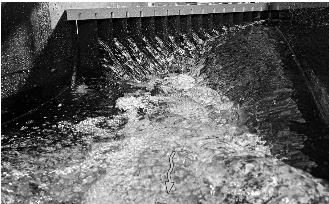
Abbildung 5.6 Detailaufnahme der Abströmung eines Leitrechens bei hohen Fließgeschwindigkeiten
