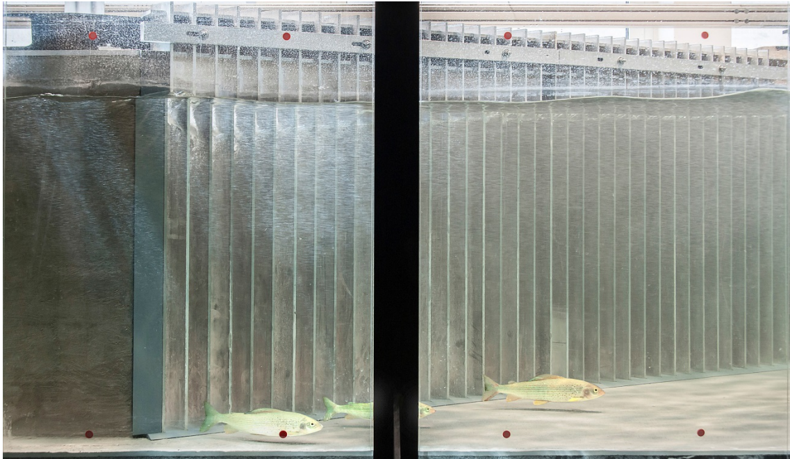
Abbildung 7.13 Charakteristische Ausrichtung einer Äschen-Schule parallel zur Strömungsorientierung vor dem Leitrechen; \alpha = 30^\circ , \beta = 45^\circ , B = 6 \text{ cm} ( \sigma = 0.17 )
