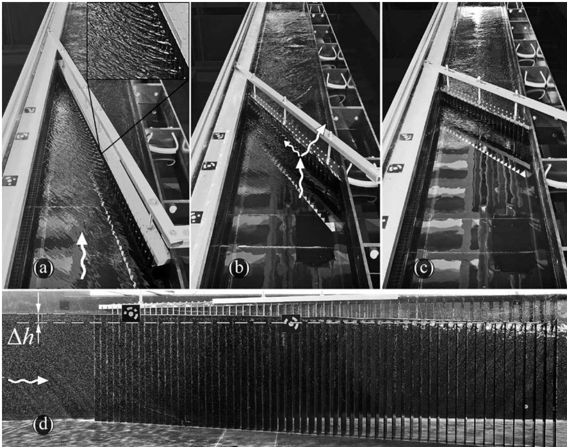
Abbildung 5.4 Partielle Strömungsumlenkung und -einschnürung oberstrom von Leitrechen mit Rechenwinkeln von \alpha = (a) 15, (b) 30 und (c) 45° und (d) Abnahme der Wassertiefe entlang des Rechenverlaufs oberstrom
