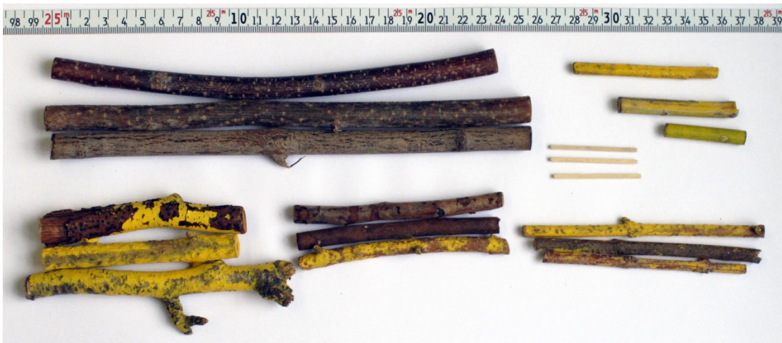
Abbildung 4.18 Schwemmh Holzklassen im hydraulischen Modell, skaliert im Massstab 1:35
