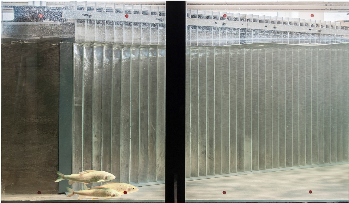
Abbildung 7.14 Verharren einer Äschen-Schule vor dem Bypass-Einlauf; \alpha = 30^\circ , \beta = 45^\circ , b = 5 \text{ cm} ( \sigma = 0.17 )
