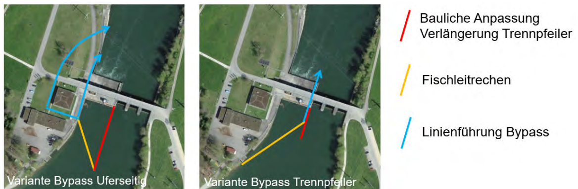
Abbildung 31: Mögliche Linienführungen eines Bypasses in Kombination mit den beiden Varianten zur Positionierung eines FLRs.
