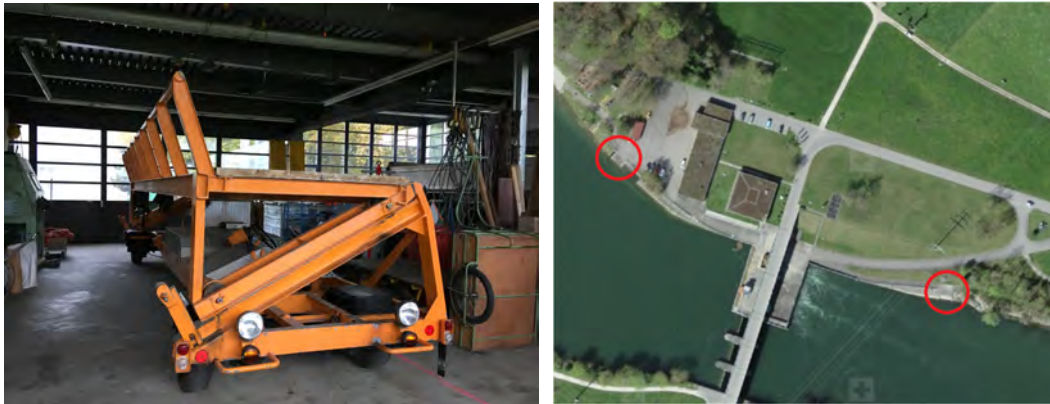
Abbildung 27: links: Bootstransportwagen zur Umsetzung der Boote; rechts: Lokalisierung der Rampen zum Ein- und Auswassern der Boote am WKW BAN.
