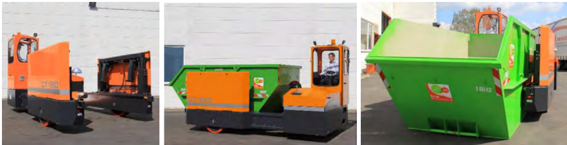
Abbildung 36: Beispiel eines vollautomatischen Muldentransporters.
