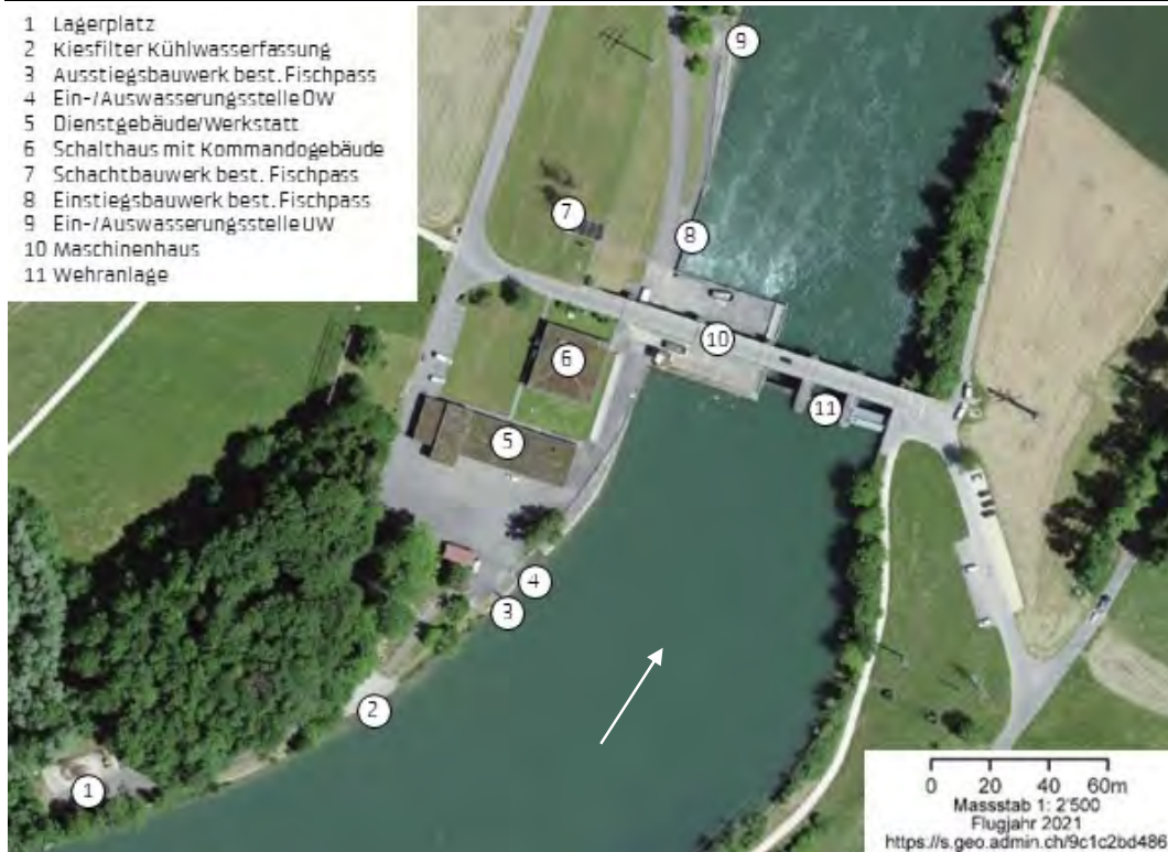
Abbildung 2: Anlageteile WKW BAN (Hintergrund: Luftbild © Swisstopo).
